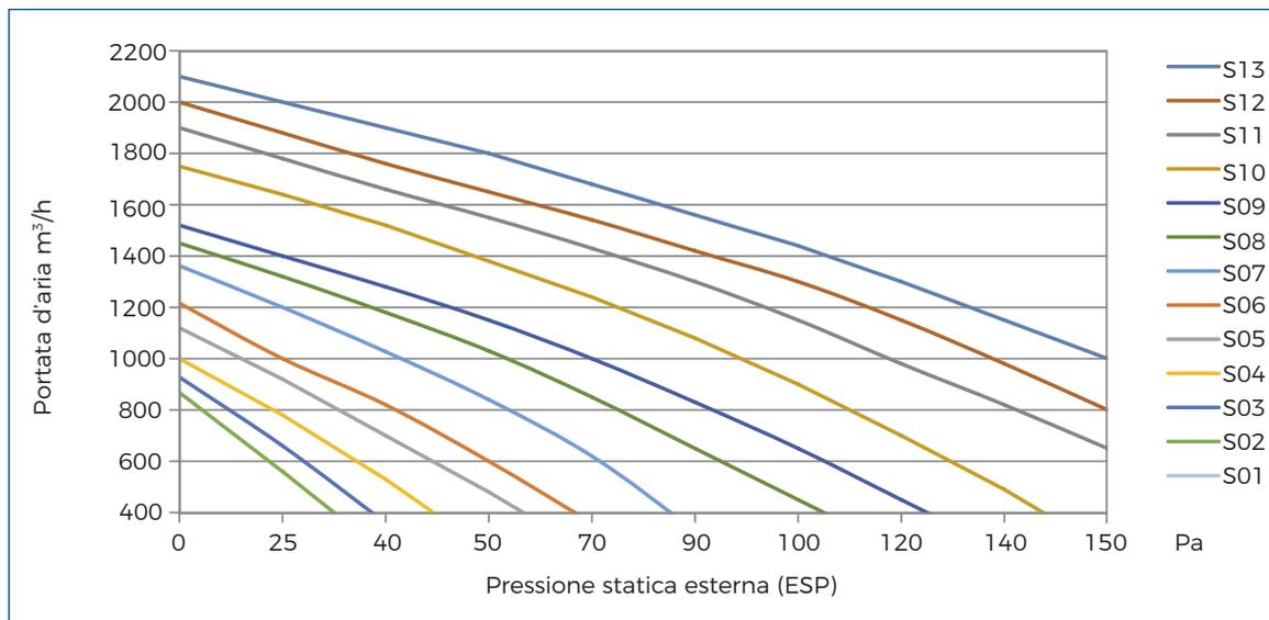
Il comando a filo può essere utilizzato per modificare la pressione statica esterna (ESP) alle velocità di ventilazione super-alta, alta, medio-alta, media, medio-bassa, bassa, quiet.
