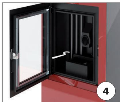
4 Con un aspiratore pulire le pareti della camera di combustione. Con un utensile pulire i tubi di scambio asportando tutto il residuo della combustione.
