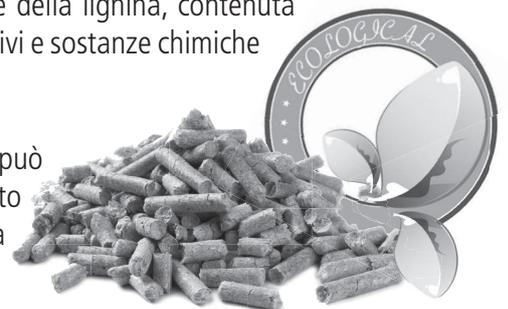
**Per i nostri prodotti utilizzare pellet con diametro 6 mm, lunghezza di 30 mm e con umidità massima del 6% e certificato A1 secondo la normativa UNI EN ISO 17225-2. Conservare il pellet lontano da fonti di calore e non in ambienti umidi o con atmosfera esplosiva.**
