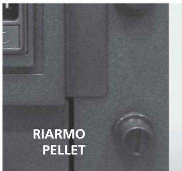
**Sicurezza temperatura pellets:** nei rarissimi casi in cui si verifica una temperatura eccessiva all'interno del serbatoio, il termostato sicurezza pellets a riarmo manuale genera un allarme **"ALAR-SIC-FAIL"** interrompendo il funzionamento della stufa; il ripristino deve essere effettuato da parte del cliente riarmando il suddetto dispositivo posto dietro la stufa.
