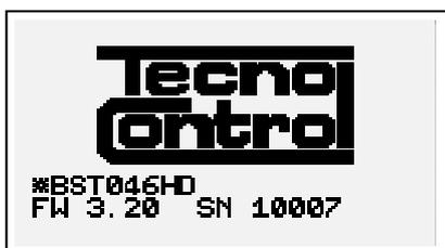
Schermata con logo, modello (es:BST046), indicazione presenza modulo bluetooth se installato (es: BT), versione del firmware dello strumento (es:fw 3.20) e numero di matricola dell'apparecchiatura (es: sn 67295)
