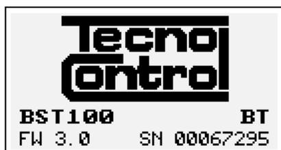
Schermata con logo, modello (es:BST100), indicazione presenza modulo bluetooth se installato (es: BT), versione del firmware dello strumento (es:fw 3.0) e numero di matricola dell'apparecchiatura (es: sn 67295)
