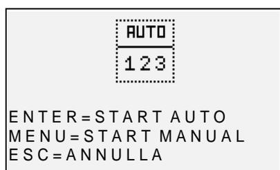
Premendo il pulsante (**ENTER**) viene avviata la procedura che effettua in automatico 3 analisi consecutive ad intervalli di 120” e ne calcola la media. Premendo il pulsante (**MENU**) viene avviata la procedura che effettua 3 analisi consecutive e ne calcola la media acquisendo i dati della singola analisi in corrispondenza della pressione del pulsante (**ENTER**), dando la
