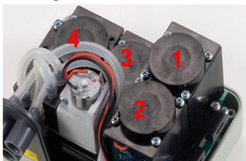
*È anche possibile la sostituzione della pompa o addirittura della camera d'analisi, evitando così in caso di necessità la spedizione alla casa costruttrice o al rivenditore.*
