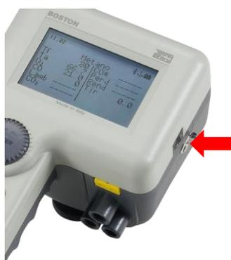
*Lo strumento è predisposto per gestire, con sistema di auto identificazione, delle sonde esterne (per la misura di parametri vari)*
