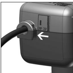
**NOTA:** Il collegamento del cavo di alimentazione deve avvenire internamente ad una scatola di derivazione che garantisca una protezione IP54 o superiore
