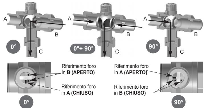
Il servocomando ruota di 90° in senso **ORARIO** per passare dalla posizione di apertura alla posizione di chiusura
