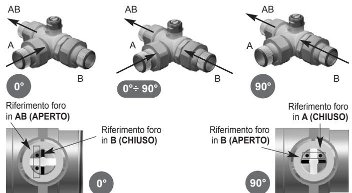
Il servocomando ruota di 90° in senso **ORARIO** per passare dalla posizione A - AB alla posizione B - AB
