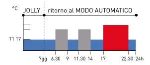
ESEMPIO: Modo Automatico - Jolly per 1 settimana - concluso periodo Jolly il cronotermostato riprende il modo automatico. T1: Temperatura manuale impostabile 2 a 40°C.
