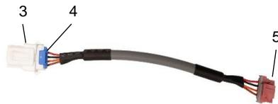
Fig. 26: cavo di connessione. Il terminale 3 è il terminale di protezione; collegare il terminale 4 al terminale 2 del cavo di collegamento; collegare il terminale 5 al terminale del comando a filo del condizionatore d'aria.
