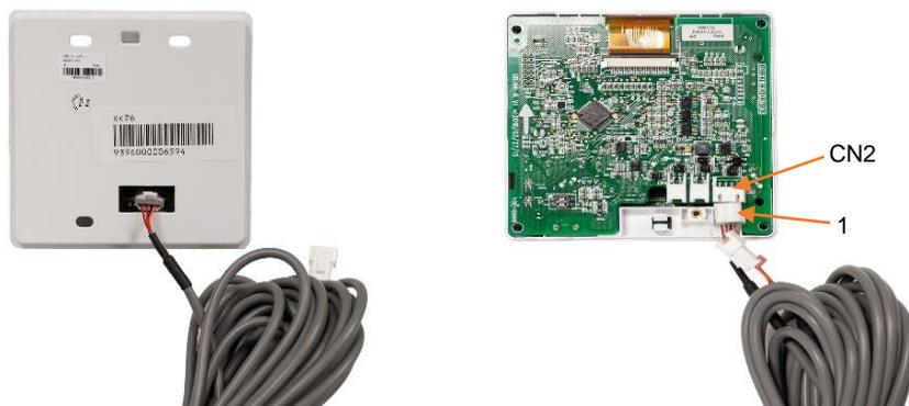
Fig. 27: Schema di connessione tra il comando a filo e il cavo di collegamento: Inserire il terminale 1 del cavo di collegamento nei morsetti CN2 della scheda madre
