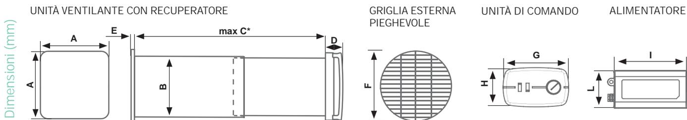
\* per spessori di parete inferiori a 280mm tagliare il tubo a seconda della propria necessità ed utilizzare una griglia esterna standard (non in dotazione)
