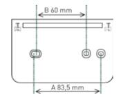
Per separare dal corpo frontale lo zoccolo per il fissaggio, togliere il coperchio del vano porta pile e svitare dall'alto le viti, ruotando il corpo dell'apparecchio verso il basso per estrarlo.
