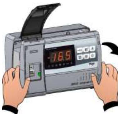
**Fig. 5:** Esercitare una pressione sui lati di ogni singola cerniera per estrarla dalla propria sede e rimuovere completamente il frontale.
