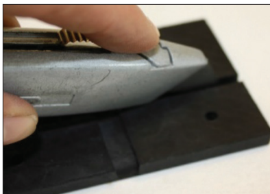
Immagine #1. Tagliare l'AV Pad a misura per il montaggio orizzontale
