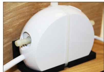
Immagine #2. Fissaggio della mini pompa all'AV Pad
