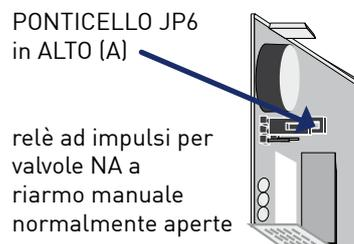
PONTICELLO JP6 in ALTO (A) relé ad impulsi per valvole NA a riarmo manuale normalmente aperte
