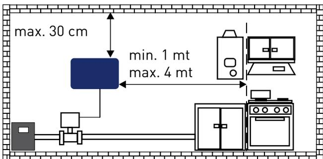
Il METANO essendo un gas più leggero dell'aria, la concentrazione massima si avrà in prossimità del soffitto. Installare a circa 2 metri (minimo 1 mt. massimo 4 mt) dall'apparecchio utilizzatore del gas e a 30 cm. dal SOFFITTO.
