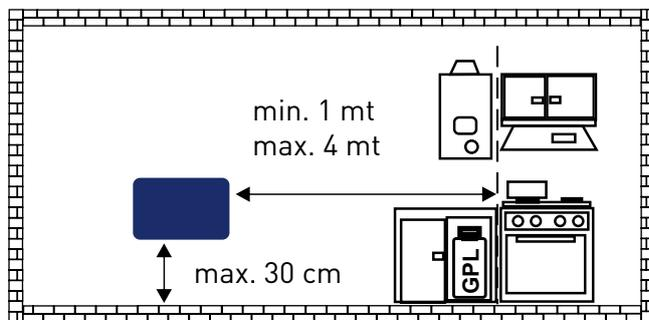
Il GPL essendo gas più pesante dell'aria, la concentrazione massima si avrà in prossimità del pavimento. Installare a circa 2 metri (minimo 1 mt. massimo 4 mt) dall'apparecchio utilizzatore del gas e a 30 cm. dal PAVIMENTO.
