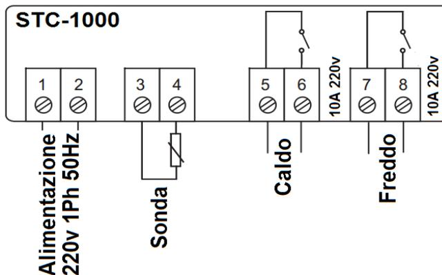
Il controllore STC-1000 è uno strumento a sonda singola studiato per il controllo della temperatura caldo/freddo tramite due circuiti separati. Controlla un sistema di riscaldamento ed un sistema di refrigerazione tramite due relè ed impostazioni separate. Ideale per controllo temperatura acquari.
